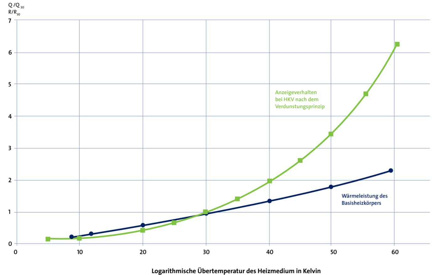
Q = Wärmeleistung des Heizkörpers
