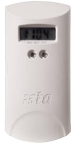
körper-Oberflächentemperatur am Montagepunkt erfasst. In der Elektronik des Gerätes wird ein Festwert (20°C) für die Raumluft simuliert. Die Elektronik bildet die Differenz aus der gemessenen Heizkörper-Oberflächentemperatur und der auf 20°C festgelegten Raumlufttemperatur. Sobald eine Heizkörper-Oberflächentemperatur von 28°C erreicht ist, registriert der doprimo picco die Wärmeabgabe und beginnt zu messen.
