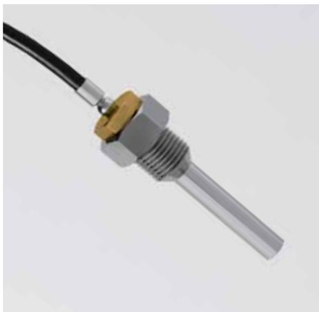
Die Temperaturmessung in Vor- und Rücklauf erfolgt durch Temperaturfühler aus Platin, die höchste Genauigkeit bei der Ermittlung der Temperaturdifferenz garantieren. Bei den kombinierten Wärmehählern sind sie nicht direkt am Rechenwerk angeschlossen, sondern müssen separat bestellt und angeschlossen werden. Die Temperaturfühler stehen in 3 m Länge mit 2-Leiter-Technik und in 10 m und 30 m Länge mit 4-Leiter-Technik zur Verfügung.
